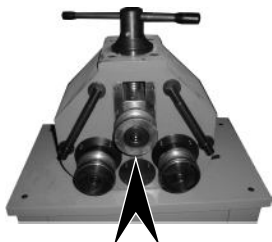
nalévací otvor oleje převodovky (v prostoru pod rolnou)
